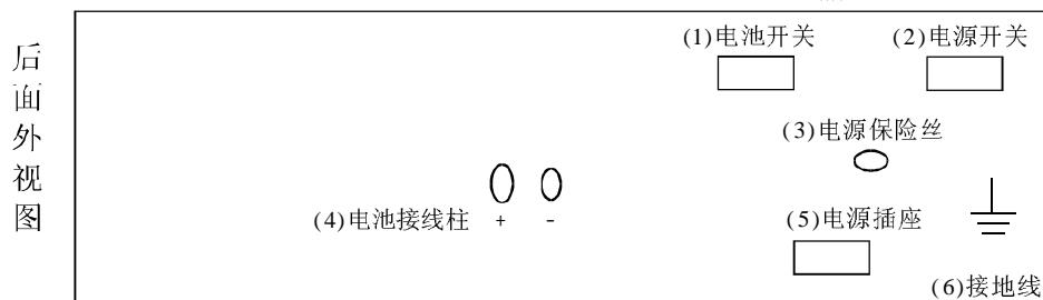
备注： (1) 电池开关。如果使用备电池，关机时此开关也要关闭。 (2) 电源开关。
