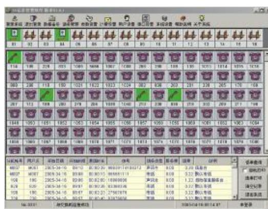
若第一次运行时显示“与交换机通讯失败是否继续?”对话框时(如图a)，请选择“是”继续进入软件主程序界面，然后点击“串口设置”按键(如图b)，确认电脑串口位置后选择“保存”(如图c)，串口设置正确后如还出现此问题，请检查电脑与交换机的连接线。
